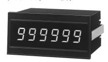
DINサイズ96mm(W)x48mm(H) 5000時間記憶保持機能付 ラッチ付 リーディングゼロサプレス機能 センサ用電源内蔵DC12V 50mA 電源電圧 AC 90~132V
