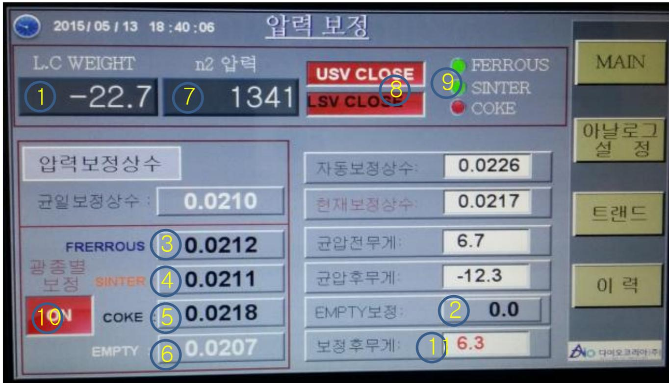
예시1] FERROUS 장입시 인디게이터 입력 L.C 50TON, 균압후 압력 보정 무게가 52.6 TON 이 되었을때 압력 보정상수 수정 하기.
